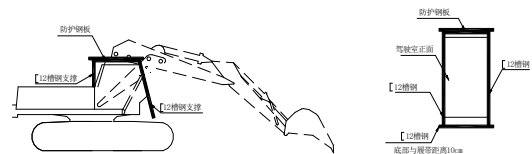
图 7 反铲防护钢板安装示意图
