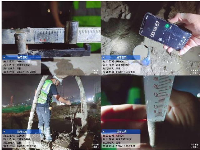
图 3 浇筑前泥浆参数测定图
