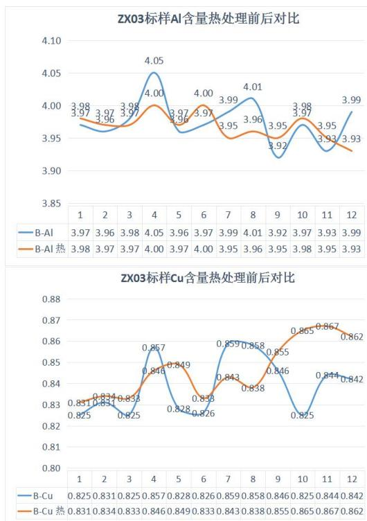
从 ZX03 直读光谱 AB 两组 Al、Cu 元素分析结果可以看出，标样进行热处理后 Al、Cu 值变化较为稳定，同时从两组光谱曲线分布图可以明显看出热处理后的 Al/Cu 值走势相对稳定。
